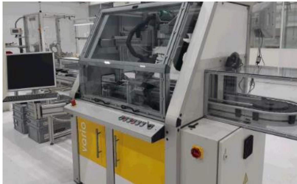
Линия пайки реле PLC и УЗИП контактов
