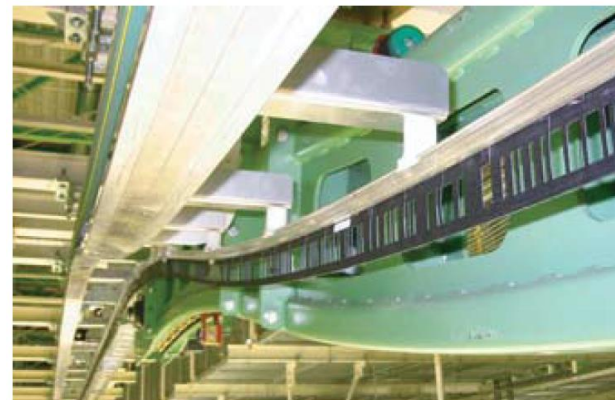
Компоненты системы WCS3B с применением алюминиевого профиля
