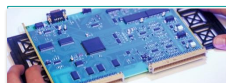
08 Ультрафиолетовая инспекция нанесенных влагозащитных покрытий
