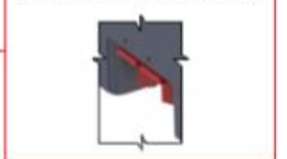
Ключи кодировки слота (за контактом заземления)
