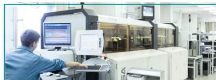
03 Селективный автоматизированный монтаж объёмных компонентов (DIP)
