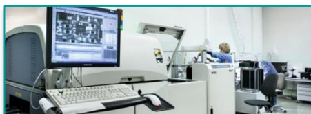
05 Неразрушающая инспекция монтажа АОИ
