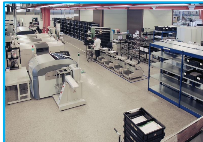
Линии поверхностного монтажа с производительностью до 80 000 компонентов в час
