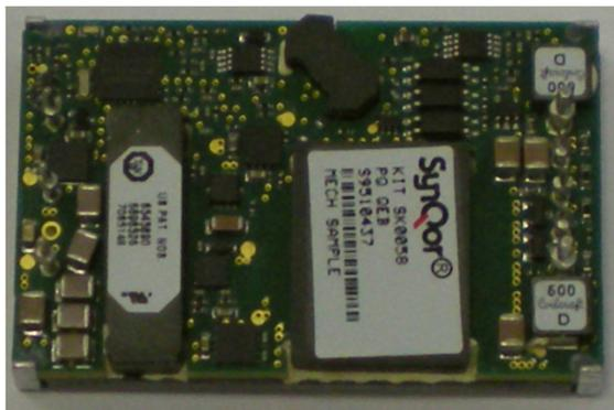
ИВЭП изготовленные по гибридно-пленочной технологии
