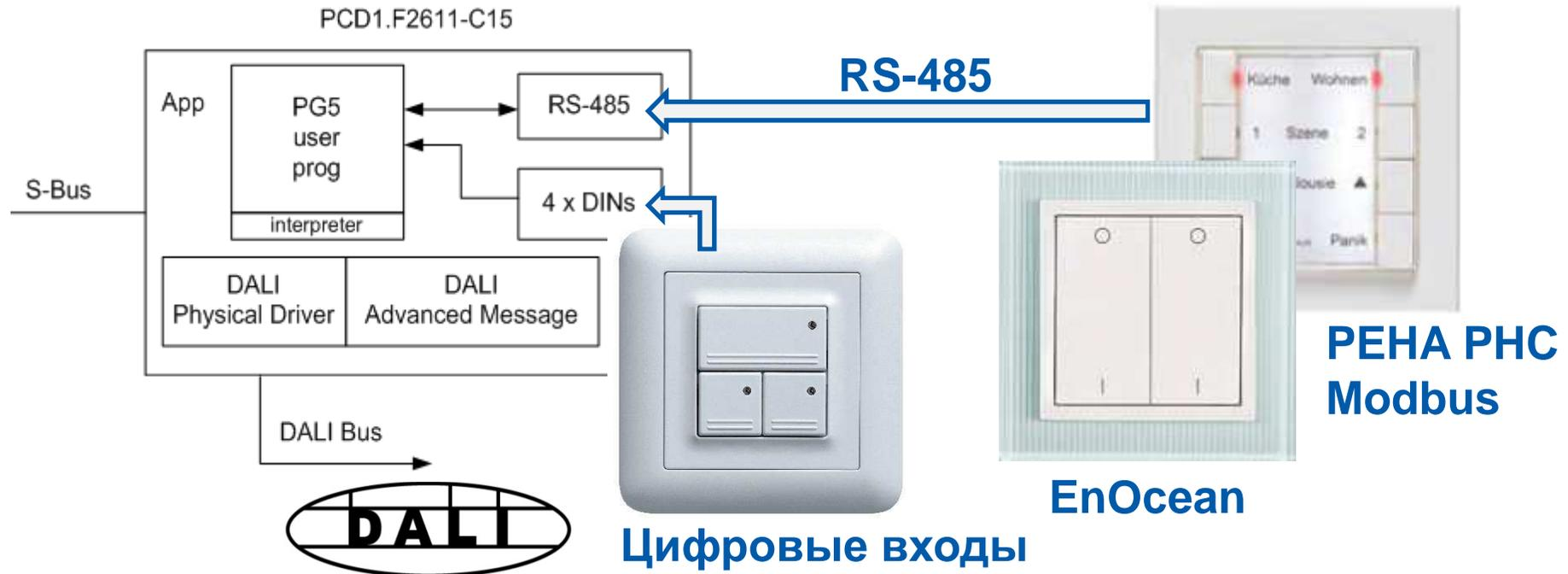
Дополнительный интерфейс RS485 может использоваться для подключения сторонних операторских панелей по любому протоколу на RS485. Например EnOcean или PEHA-PHC или любые другие Modbus панели.
