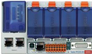
Модульный контроллер PCD3.6880 с 2 портами Ethernet TCP/IP и сопроцессором для горячего резервирования.
