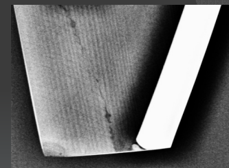
Трещина лопасти винта под лакокрасочным покрытием
