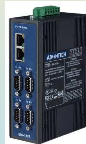
Четырех портовый шлюз данных Ethernet в RS232/422/485 EKI-1524, к нему подключаются все устройства
