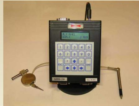
Датчик перемещения индуктивный с измерительным прибором БИН-2И
